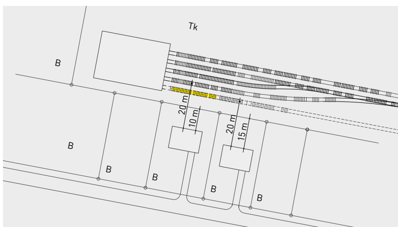
8 Ograniczenia na działce kolejowej, wynikające z zainwestowania działki budowlanej
