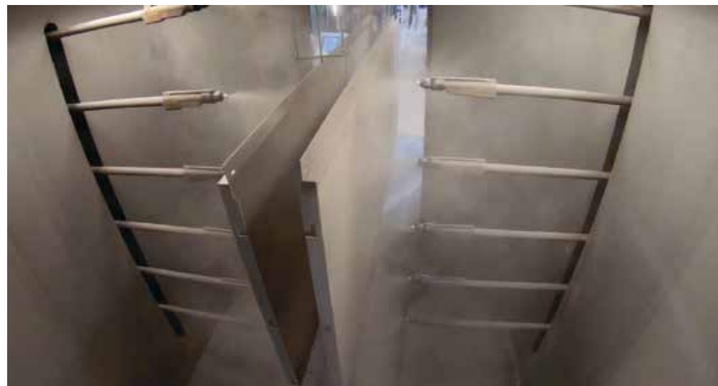
Etap pokrycia farbą proszkową na zautomatyzowanej linii.
